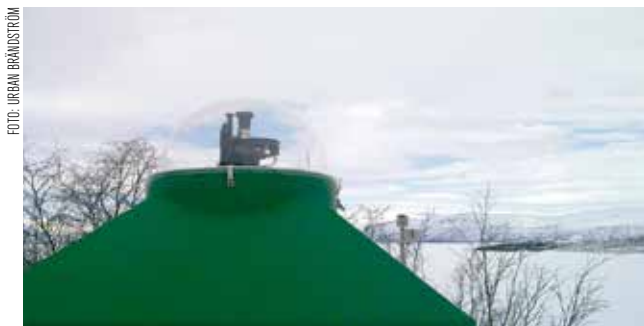
Meteorkameran ALISA i Abisko ingår i Swedish Allsky Meteor Network. Den registrerar kontinuerligt meteoror under mörka förhållanden. Bakom den syns en annan kamera som registrerar norrsken i nätverket ALIS.
